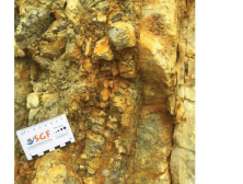
8023 - détail zone cataclásée et bréchique oxydée avec filon de quartz
